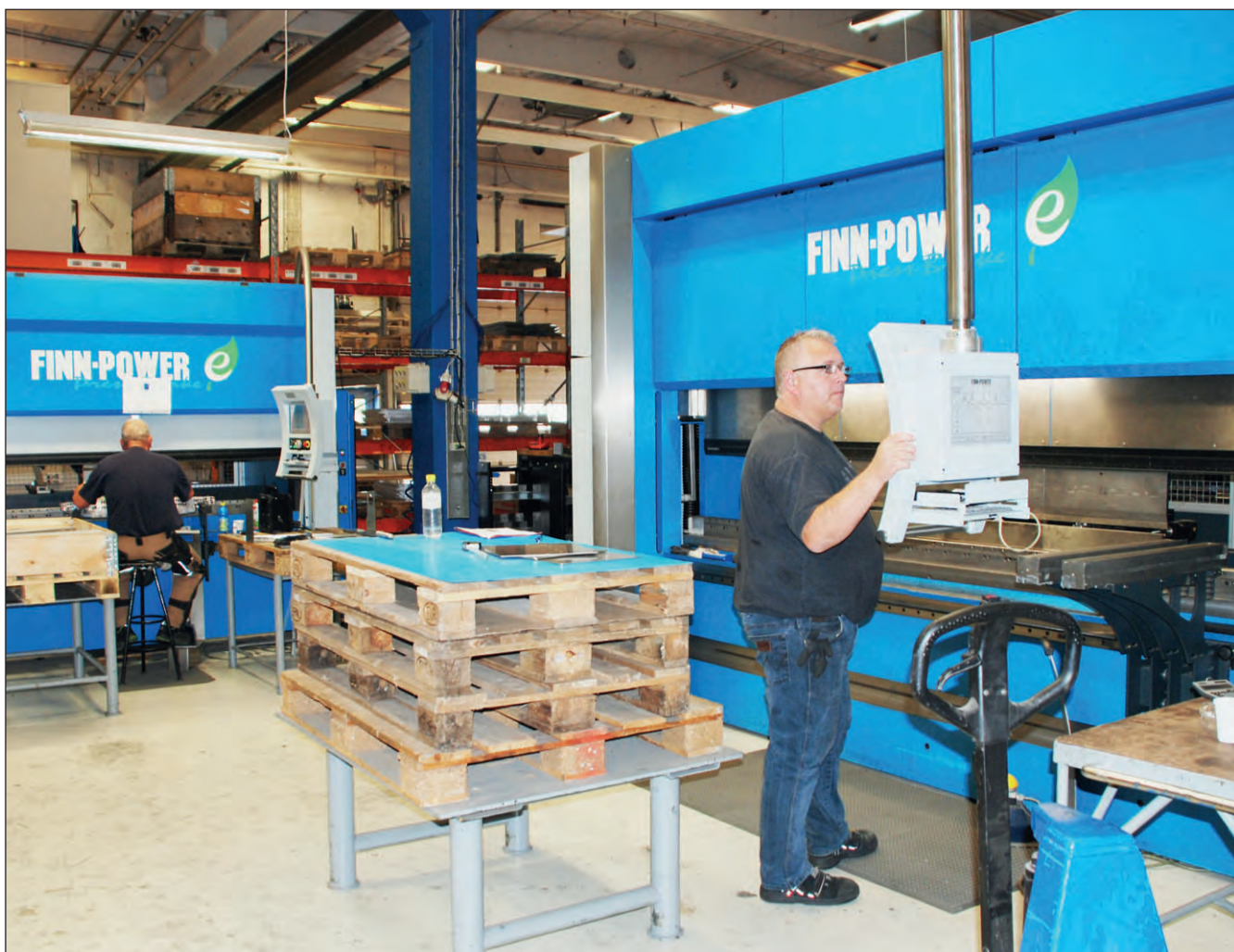
Efter installationen af Salvagnini kantbukkeautomaten har man dannet en celle for kantbukning med den italienske maskine og tre Finn Power kantpresser.
