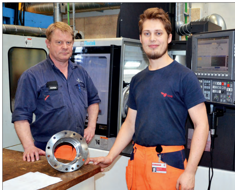
Teamleder Steen Ebling og industritekniker-lærling Troels Nielsen foran Okuma CNC-drejebænken, der betyder at emner, der tidligere blev slebet, nu kan afdræjes på mål.
