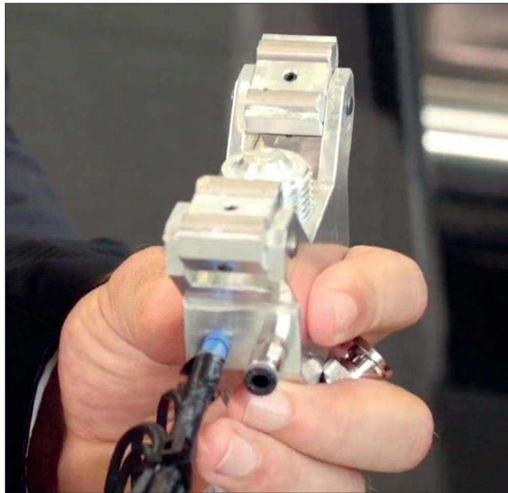
Den seneste satsning på Inject 4.0-siden er overvågning af snekken med en ultralydssensor.
