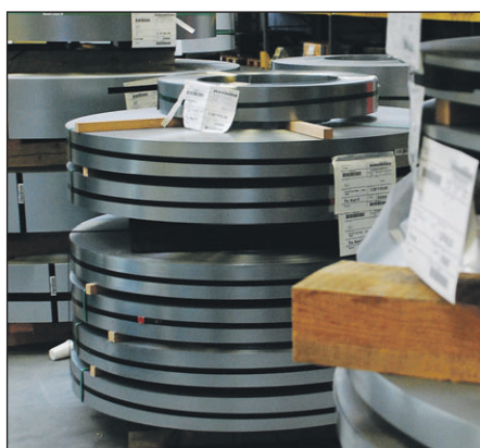
Spaltet coil-materiale klar til profilvalsning.
