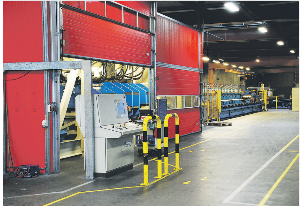
Profilvalselinjen her, registreret som maskine nummer 882, er med en total længde på godt 70 meter en af de store Dreistern anlæg der ofte kører i døgndrift på krævende opgaver. Den er blandt andet udstyret med en stor stansesektion og dobbelt 10 tons coilafvikler.
