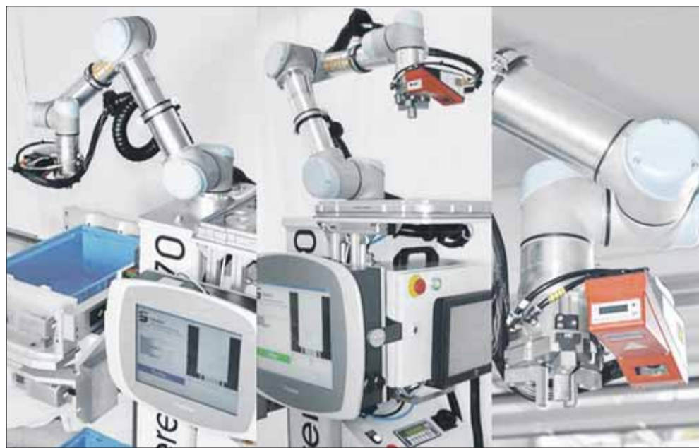
Danske Universal Robots-robotarme er oplagte til Bin Picking-løsninger med de seneste profilscanneteknologier, fremhæver Leuze.
