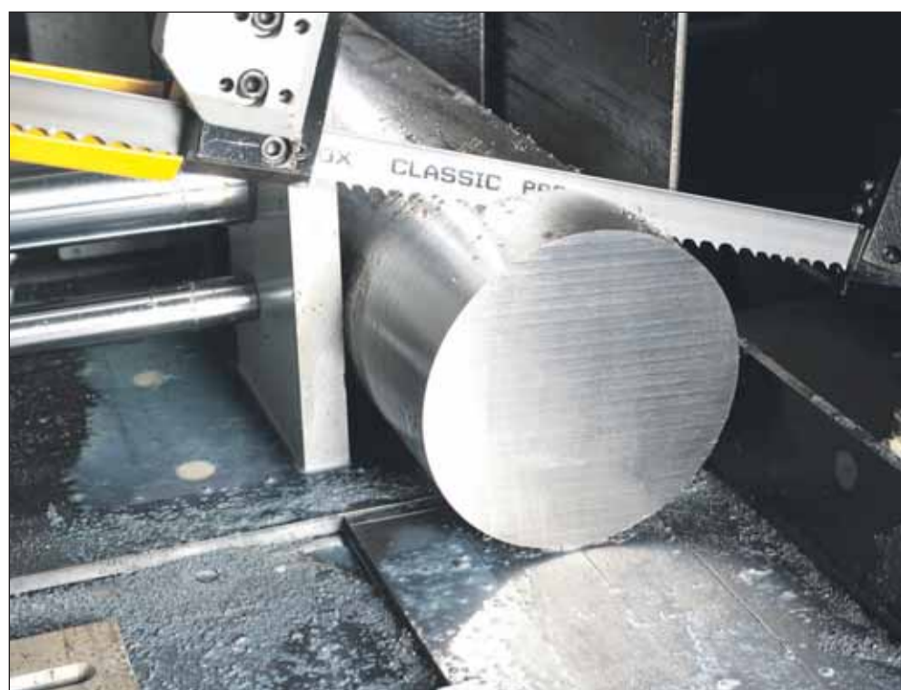
Kyocera Unimerco lancerer det aktuelt udviklede Lenox Classic Pro-bånd til både aluminium, lavtlegeret stål, rustfrit stål og værktøjsstål. Samtidig fremhæves båndets evne til at levere fine overfladekvaliteter.
