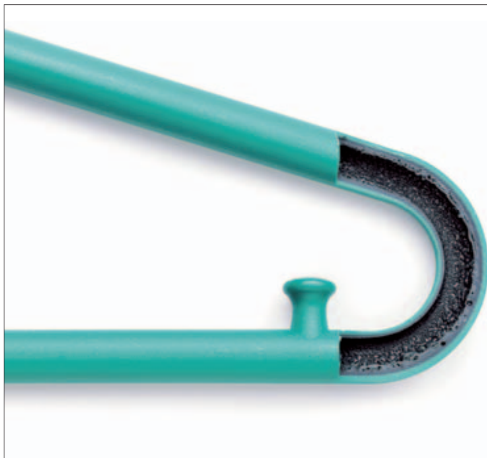
Lokal gasinjektion kan forebygge sugninger i visuelt kritiske plastoverflader, såsom denne skærm til en græsklipper.
