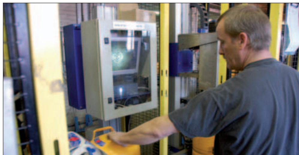
Endnu et job for prøvemesteren er den indvendige inspektion af gasflaskerne. Et kamera fotograferer den indvendige del. Hvis alt er i orden får den en mærkat på og er klar til iskruining af ventil og yderligere mærkning.
