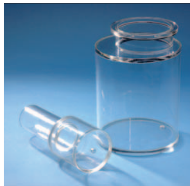
Denne transparente beholder er lasersvejst ved brug af laserabsorberende coating i samlingerne.
