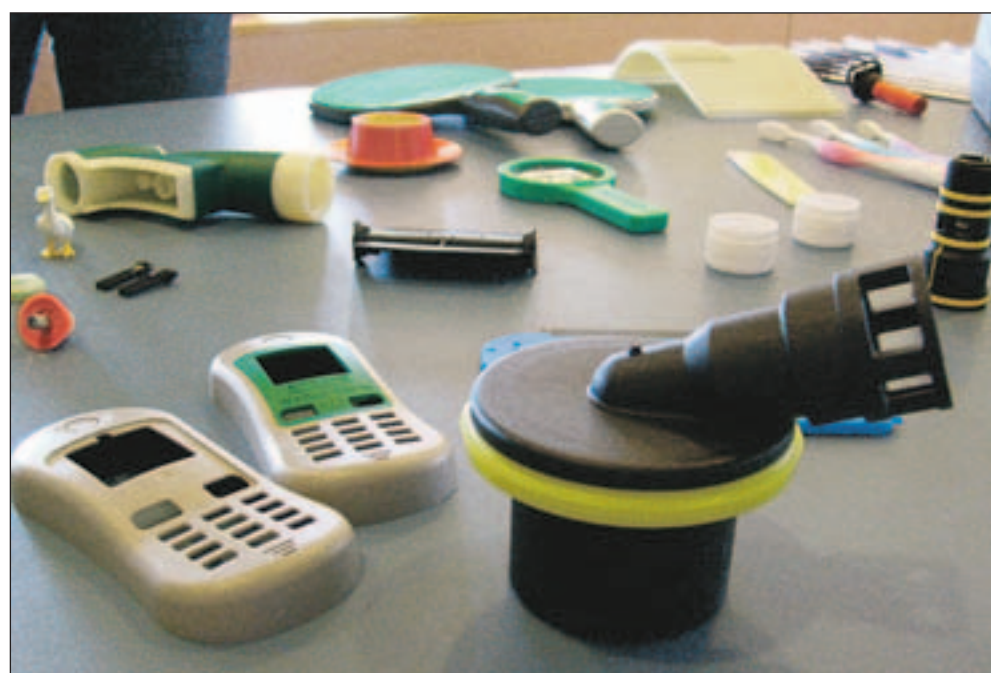
Her ses et udvalg af tekniske og dagligdags komponenter fremstillet af mere end en plasttype ved multikomponent plasticsprøjtestøbning.
