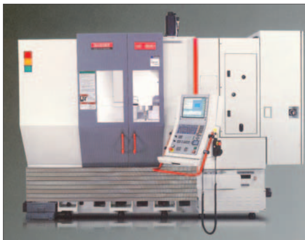
De to seneste stangautomater fra tyske Index, C100 og C200, er konstrueret til bearbejdning af stangdimensioner på henholdsvis Ø30 - Ø42 millimeter og Ø65 - Ø90 millimeter.
