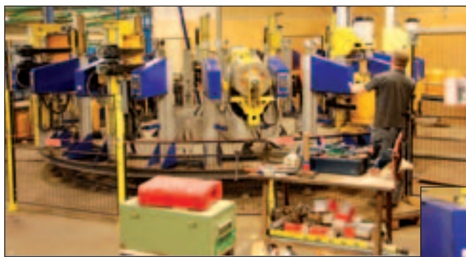
Når flaskerne er tømt for gas, fyldes de med vand og trykprøves i karrusellen her. Prøvemester Johnny Michelsen sørger for, at alle flasker med fejl kasseres.
