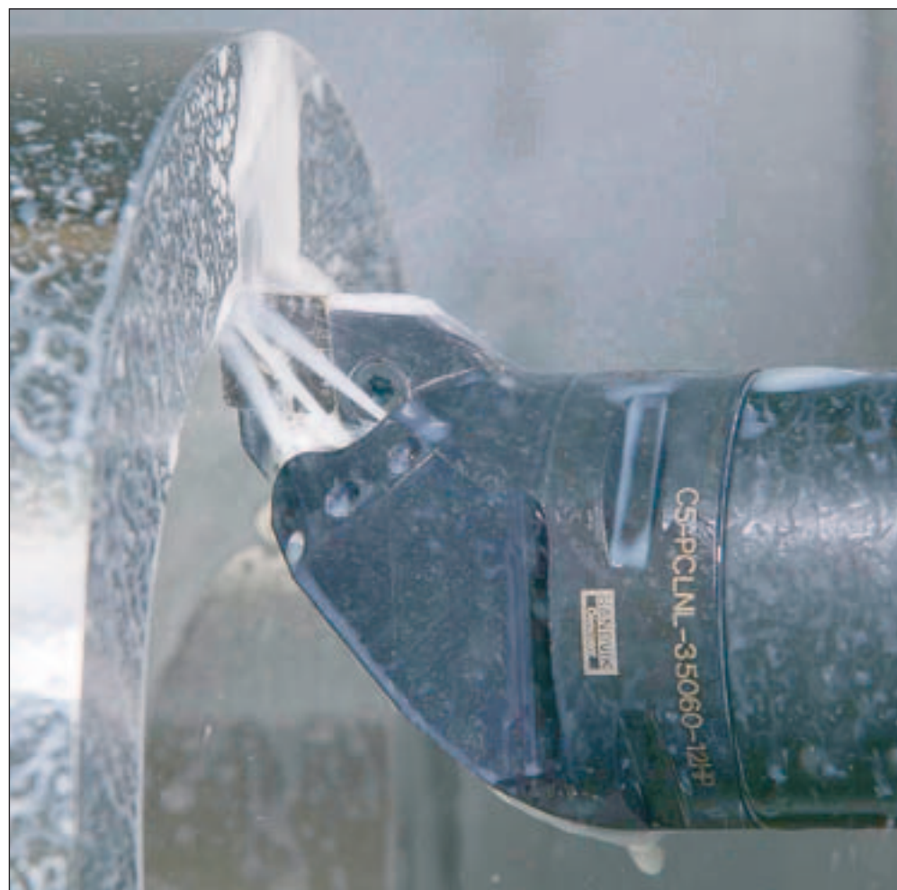
En optimeret værktøjsholder er nødvendig til bearbejdning i varmebestandige superlegeringer, hvor der arbejdes med kølevæsker ved højt tryk - 70 bar og højere.
