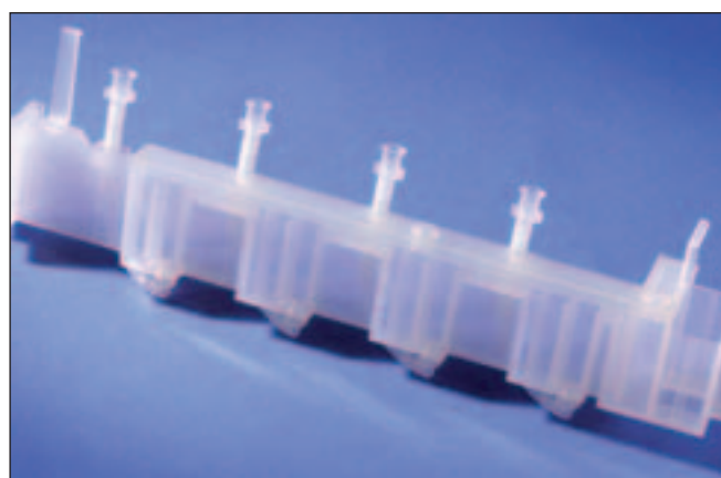
Lasersvejsning er velegnet til samling af fine detaljer i komplicerede emner.
